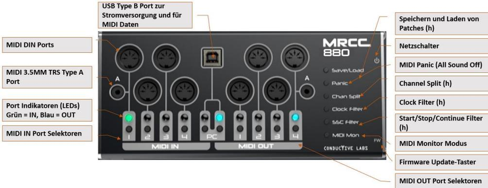
(h) = Halten Sie den Taster gedrückt, während Sie einen Eingangsanschluss auswählen, auf den der Filter angewendet werden soll. Das MRCC 880 zeigt durch Blinken der LEDs an, dass der richtige Anschluss gewählt wurde.
